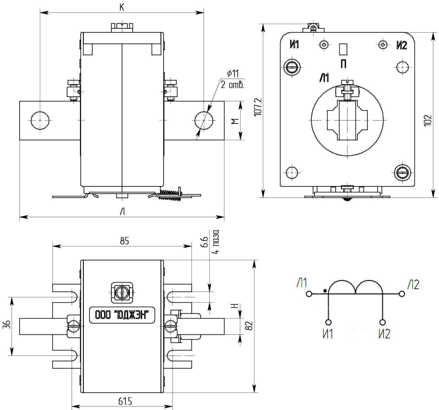
Рис. А.1 Габаритный чертеж, схема электрическая принципиальная
